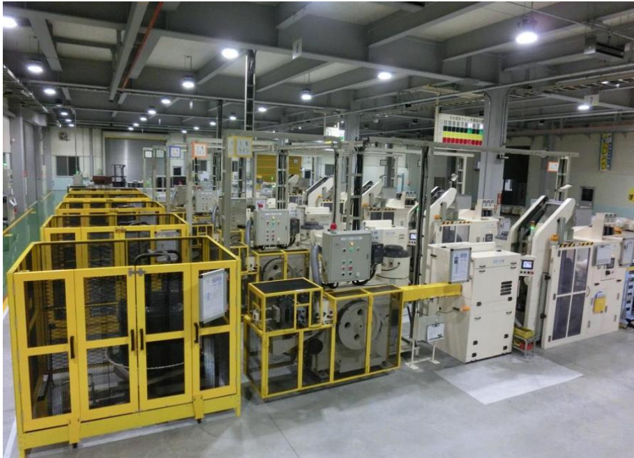
『SIMPLE & COMPACT』に拘り完成した『ばね座金』の製造ライン
