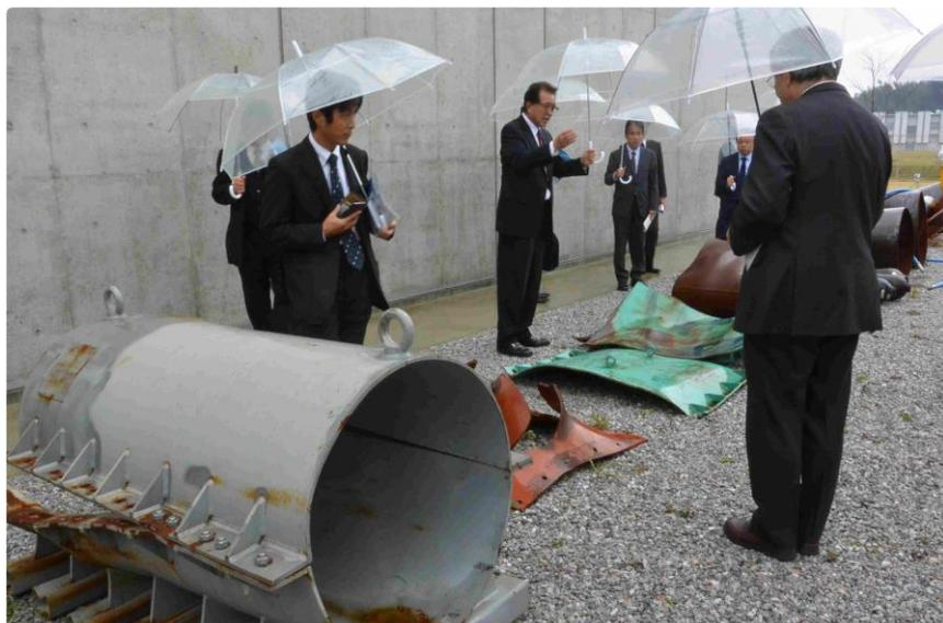
【耐圧試験で破損した試験片（HyTReC にて）】
